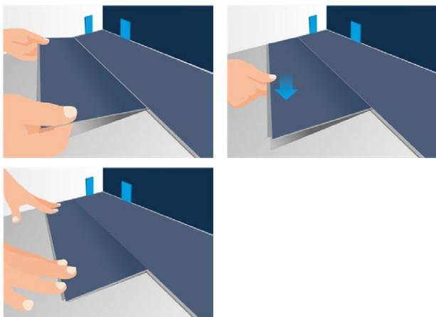
Este método se utiliza luego para instalar todas las demás filas. Asegúrese de que las juntas de los extremos estén desplazadas al menos 30 cm en las filas individuales para lograr la mejor instalación. Para instalar la última fila, se mide la distancia entre la pared y la fila instalada y se transfiere al panel. La última fila instalada debe tener la mitad del ancho de un panel que sea posible.
